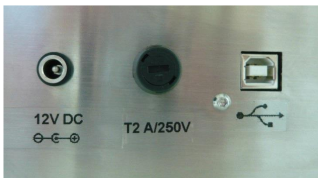
Obrázek 2: Možnosti připojení zařízení (zadní strana přístroje)
