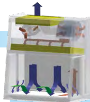
schéma proudění vzduchu u biohazardního boxu třídy II
